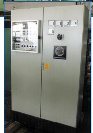
Dann erfolgt Teil für Teil der Wiederaufbau. Jede Maschine erhält natürlich eine neue elektrische und pneumatische Steuerung, basierend auf der neuesten technologischen Entwicklung.
